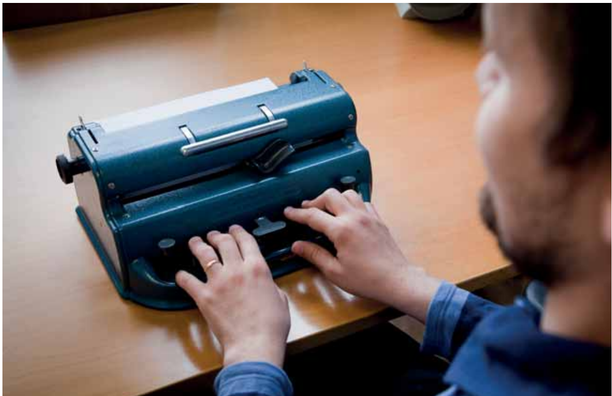
Yhdestä A4-arkista mustavalkoista tekstiä tulee neljä koneella kirjoitettua tai pistekirjoittimella tulostettua pistekirjoitusarkkia. Kuvassa on Perkins-pistekirjoituskone.
